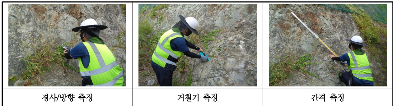
【사진 24.3.2】 불연속면 측정 현황
